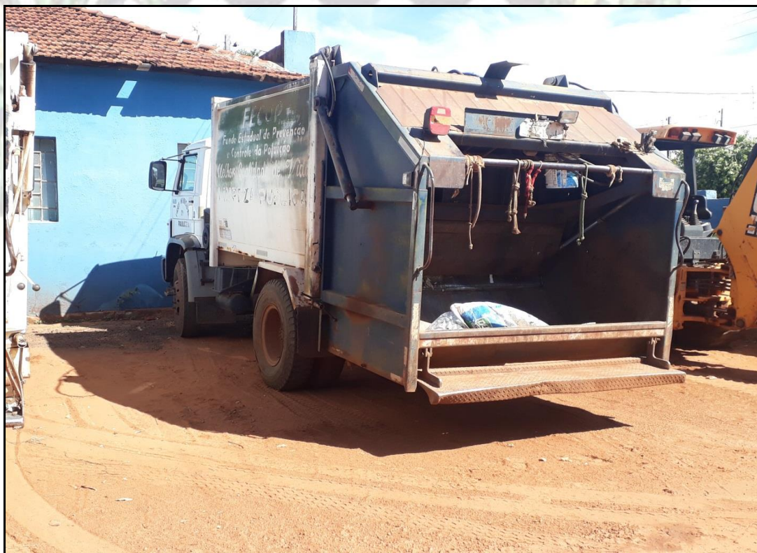
Fotos 02 – Caminhão Prensa utilizado para a coleta dos resíduos domiciliares.
