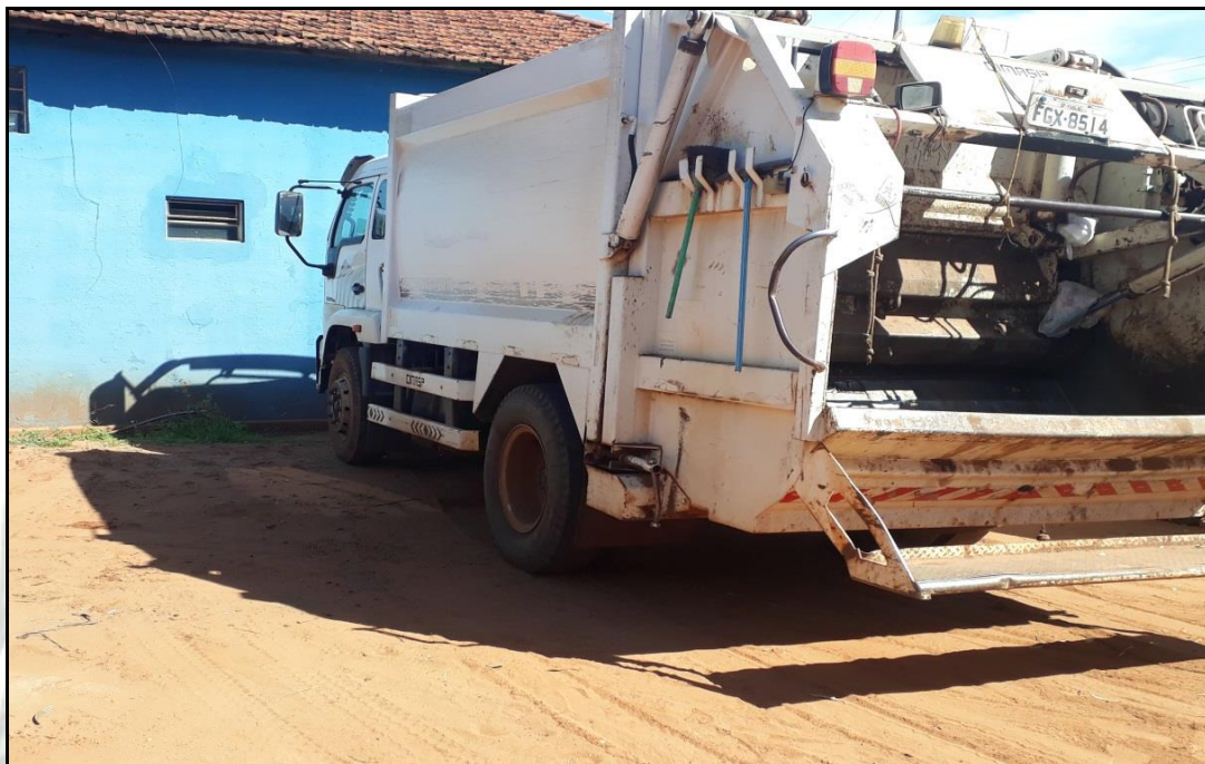
Fotos 02 – Caminhão Prensa utilizado para a coleta dos resíduos domiciliares.
